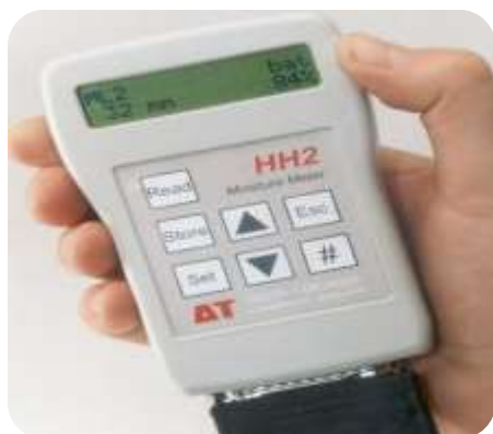
Figure 1. The HH 2 Moisture Meter (Version 2.3).
